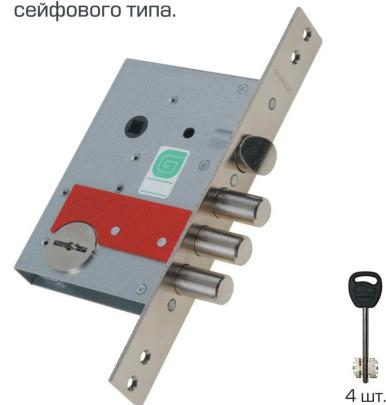
Предназначен для установки в металлические двери, шкафы и сейфы (как правого, так и левого открывания). Переворот защелки выполняется без разборки замка. Бронепластина надежно защищает от высовывания. Дополнительно защищен от самоимпрессии (патент на ПМ № 100538), декодирования (патент на ПМ № 102224). Устанавливается с ручками: "Гардиан 41.31", "Белла", с раздельной фурнитурой.
