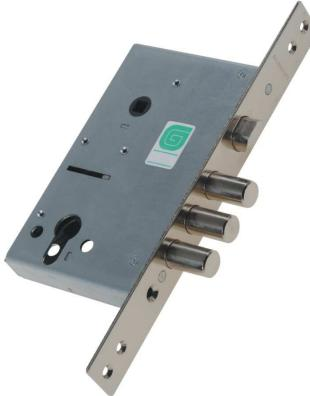
Предназначен для установки в металлические двери, шкафы и сейфы (подходит как для дверей правого, так и левого открывания). Переворот защелки выполняется без разборки замка. Возможна установка броненакладки. Устанавливается с ручками: "Гардиан 41.32", "Гретта", "Диана", с раздельной фурнитурой, с ручками на планке (межосевое расстояние 85 мм).
