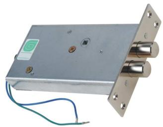
Предназначен для установки в металлические двери. Дистанционное управление с помощью радиобрелока. Величина хода ригеля – 20 мм. Конструкция защищена патентом на полезную модель № 68046. Не имеет внешних признаков установки.
